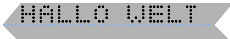
Abbildung 4: Hallo Welt in der zweiten Lochstreifenschrift
